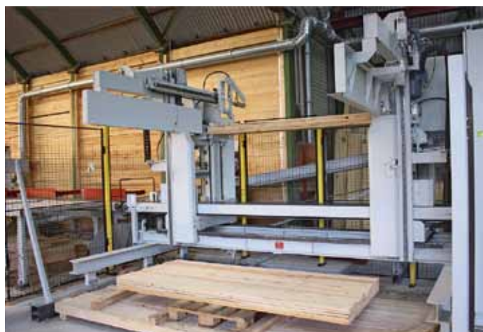
Die vierte Abwurfstation ist mit einer Reinhardt-Stapelanlage ausgerüstet – bis 3 m lange Zuschnitte lassen sich automatisch pakettieren
