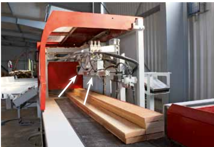
Gleich beschriftet: Während des Kappvorganges kann die Ware mit Drucker oder Stempel (s. Pfeile) beschriftet werden
