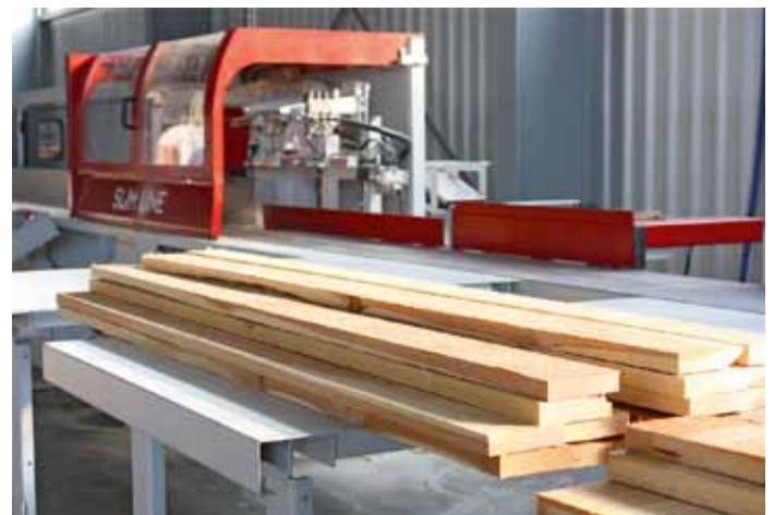
Die fertig gekappten Pakete werden entsprechend ihrer Länge auf einen der vier Stapelplätze abgeschoben
